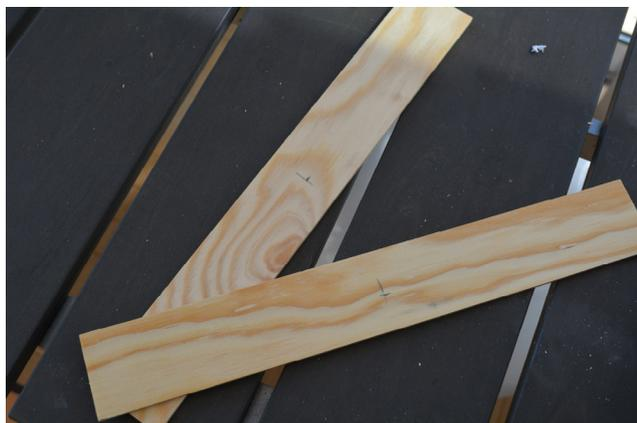
Utilisez les 4 planches de séparation pour réaliser les pieds du lit. Faites une croix au milieu des planches (en largeur et en longueur). Percez un trou sur chaque planche. Superposez les planches par 2, passez les vis à écrou dans les trous.
